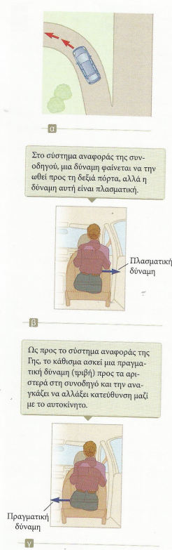
Εικόνα Μ6.10 (α) Ένα αυτοκίνητο κινείται κατά μήκος μιας καμπύλης στην έξοδο ενός αυτοκινητοδρόμου. Τι είναι αυτό που αναγκάζει τη συνοδηγό να κινηθεί προς τη δεξιά πόρτα; (β) Το σύστημα αναφοράς του συνοδηγού. (γ) Το σύστημα αναφοράς της Γης.
