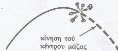
Σχήμα 9.24 (Παράδειγμα 9.15) Όταν μια οβίδα εκρήγνυται, το κέντρο μάζας των θραυσμάτων της ακολουθεί την ίδια παραβολική τροχιά που θα ακολουθούσε η οβίδα εάν δεν είχε εκραγεί.
