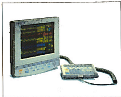
ΣΧΗΜΑ 43 Η οθόνη της συσκευής δείχνει την περιοδική φύση μερικών ζωτικών λειτουργιών του ανθρώπινου οργανισμού. Η ηλεκτρονική αυτή διάταξη εσπεύει δυναμικά (δηλ. διαρκώς) το ηλεκτροκαρδιογράφημα (ECG), την αναπνοή, και την πίεση του ασθενούς.
