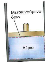
Σχήμα 4-1: Το έργο που σχετίζεται με τη μετακίνηση οριακών επιφανειών ονομάζεται έργο μετακίνησης οριακών επιφανειών ή έργο ογκομεταβολής.
