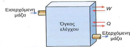
Σχήμα 2-47: Το ενεργειακό περιεχόμενο ενός όγκου ελέγχου μπορεί να μεταβάλλεται μέσω μεταφοράς μάζας, καθώς και μέσω αλληλεπιδράσεων θερμότητας και έργου.
