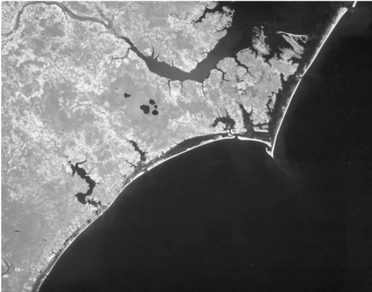
Σχήμα 1.16 Γραμμική κλαστική ακτή (Cape Lookout, N. Carolina, U.S.A). Το ύψος της φωτογραφίας είναι 110 km. Φαίνονται όλες οι κλασσικές γεωμορφές γραμμικών κλαστικών ακτών (π.χ. λιμνοθάλασσες (lagoons) ιζηματογενείς ύφαλους (bars) και φραγμούς (barriers) και ιζηματογενή βέλη (spits)) (Landsat image, τροποποιημένο από SEPM, 1996). ).
