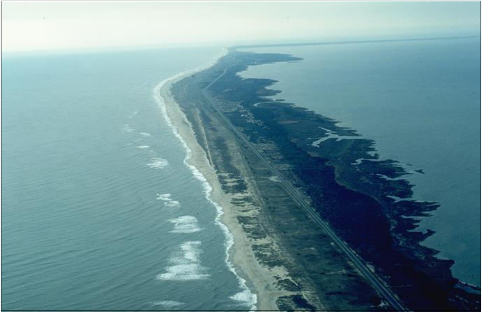
Σχήμα 4.2 Αεροφωτογραφία των Outer Banks, N. Carolina, U.S.A. Παράδειγμα παράκτιας διάβρωσης φραγματονησιδας. Προσέξτε του παλαιούς κατεστραμμένους δρόμους. (Τροποποιημένο από SEPM, 1996).
