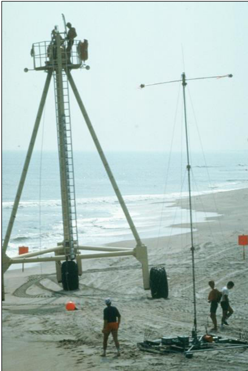
Σχήμα 8.5 U. S. Army Corps of Engineers Field Research Station, Duck, North Carolina, U.S.A. Μοντέρνες μέθοδοι μέτρησης ρευμάτων κυμάτων και βαθυμετρίας (Coast Research Amphibious Buggy (CRAB))ετοιμάζεται για να τραβήξει μια σχέδια με ρευματογράφους / κυματογράφους. (Τροποποιημένο από SEPM, 1996).
