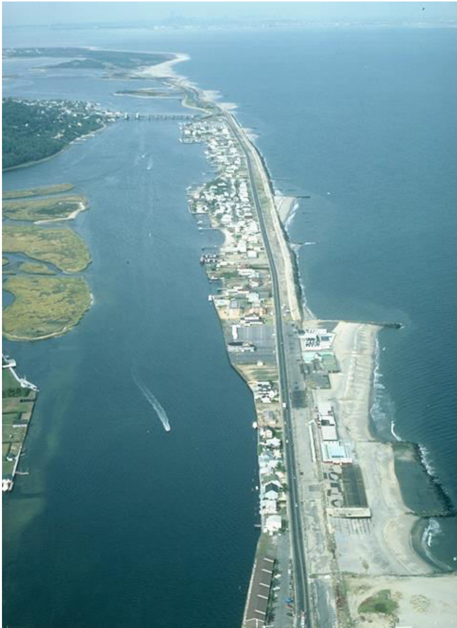
Σχήμα 11.32 Sea Bright, New Jersey, U.S.A. Πρόβολοι κάθετοι στην ακτή. (Τροποποιημένο από SEPМ, 1996).
