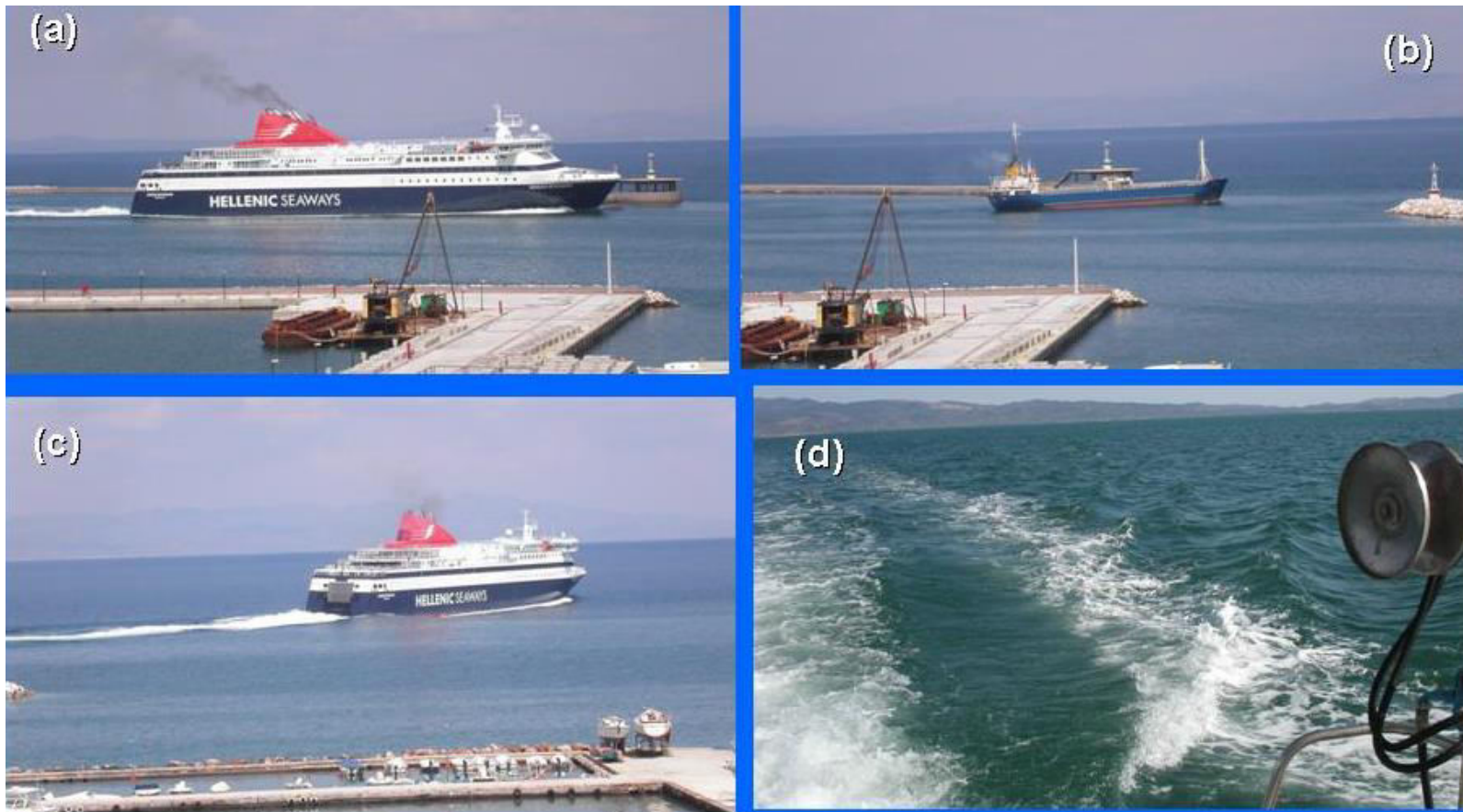
Σχήμα 11.21 Κύματα πλοίων (Ship waves) από το M/V Nissos Mykonos (141 m length, 8410 tons, operational speed 26.5 knots) στην είσοδο του λιμένα Μυτιλήνης (b) τα αργά πλοία δεν δημιουργουν σημαντικά απόνερα (d) απόνερα πλοίων
