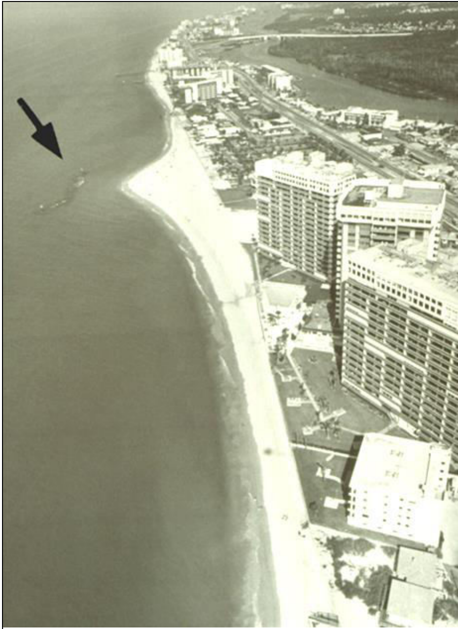
Σχήμα 9.11 Redington Shores, Florida, USA. Ο κυματοθραύστης κτίσθηκε το 1988 και έχει παγιδεύσει αρκετή άμμο με αποτέλεσμα να δημιουργεί διάβρωση στα κατάντη (downdrift). (Τροποποιημένο από SEPM, 1996).
