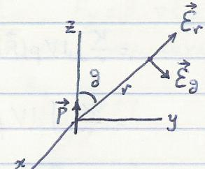
Πράγματι, το  $+q$  βρίσκεται στο  $+\frac{a}{2}$  πάνω στον άξονα  $z$  και το  $-q$  στο  $-\frac{a}{2}$ , οπότε  $\phi = \frac{1}{4\pi\epsilon_0} \left( \frac{q}{r_1} - \frac{q}{r_2} \right) = \frac{q}{4\pi\epsilon_0} \frac{r_2 - r_1}{r_1 r_2}$  όπου  $r_2 - r_1 \approx a \cos \theta$ ,  $r_1 r_2 \approx r^2$
