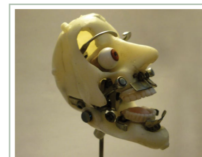
Εικόνα 217, Μηχανισμοί κίνησης κεφαλιού [35]
