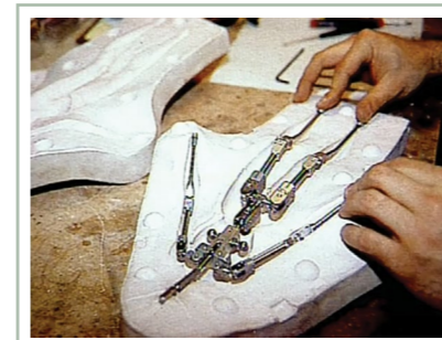
Εικόνα 166, Καλούπι για τη δημιουργία του εξωτερικού περιβλήματος μοντέλου (Nightmare Before Christmas)
