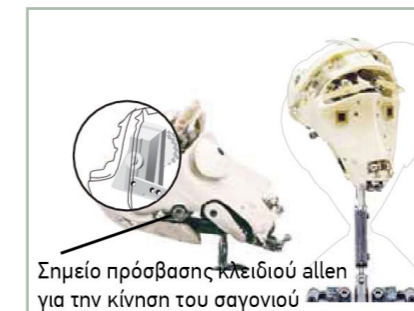
Εικόνα 218, Μηχανισμοί κίνησης με χρήση κλειδιού [36]
