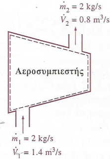
Σχήμα 4-19 Κατά τη διάρκεια μιας διεργασίας σταθεροποιημένης ροής, οι ογκομετρικές παροχές δε διατηρούνται κατ'άνγκη σταθερές.
