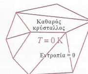
Σχήμα 6-21 Στο απόλυτο μηδέν, μια καθαρή ουσία βρίσκεται σε τέλεια τάξη και η εντροπία της ισούται με μηδέν (τρίτος νόμος της θερμοδυναμικής).
