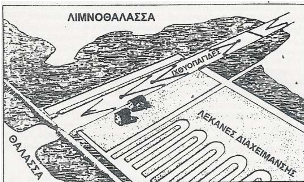
Εικ. 28. Σχηματική απεικόνιση λιμνοθαλασσοκαλλιέργειας κλειστού τύπου (vallicoltura) που συναντάται σε ορισμένες λιμνοθάλασσες της Μεσογείου κυρίως στην Β. Ιταλία
