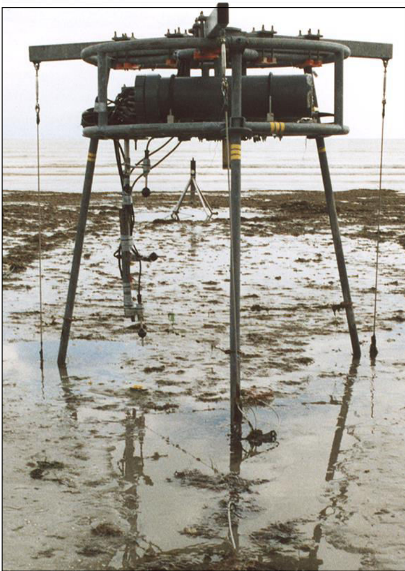
Σχήμα 6.14 Τρίποδας οργάνων AQUILLA και ολοκληρωμένο όργανο VALEPORT 808 (SOES SOC) για την μέτρηση υδροδυναμικών και ιζηματολογικών διεργασιών στην παράκτια ζώνη (τοποθέτηση οργάνων στην άμπωτη)
