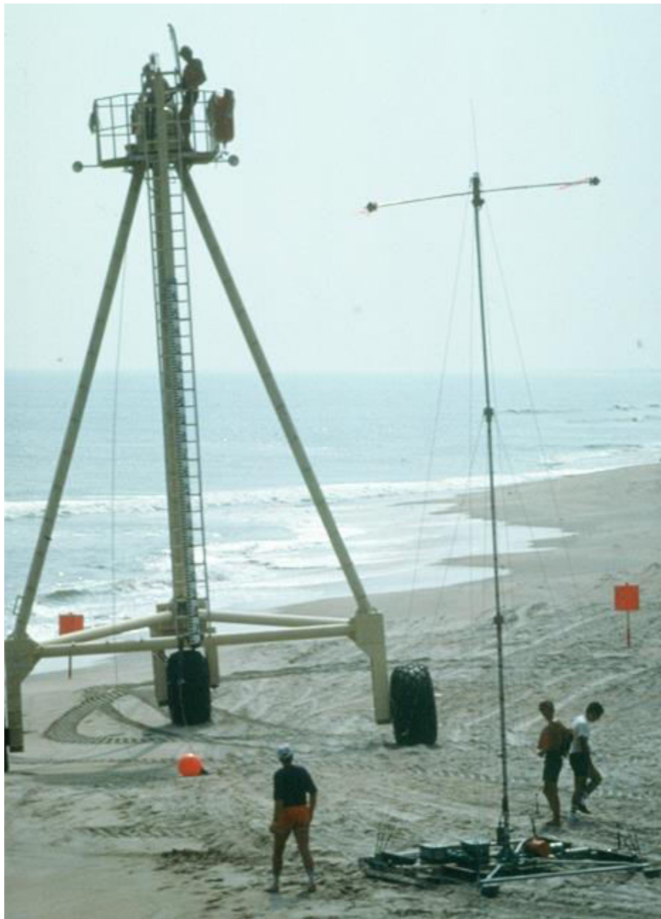
Σχήμα 5.25 U. S. Army Corps of Engineers Field Research Station, Duck, North Carolina, U.S.A. Μοντέρνες μέθοδοι μέτρησης ρευμάτων κυμάτων και βαθυμετρίας (Coast Research Amphibious Buggy (CRAB))ετοιμάζεται για να τραβήξει μια σχέδια με ρευματογράφους / κυματογράφους. (Τροποποιημένο από SEPM, 1996).
