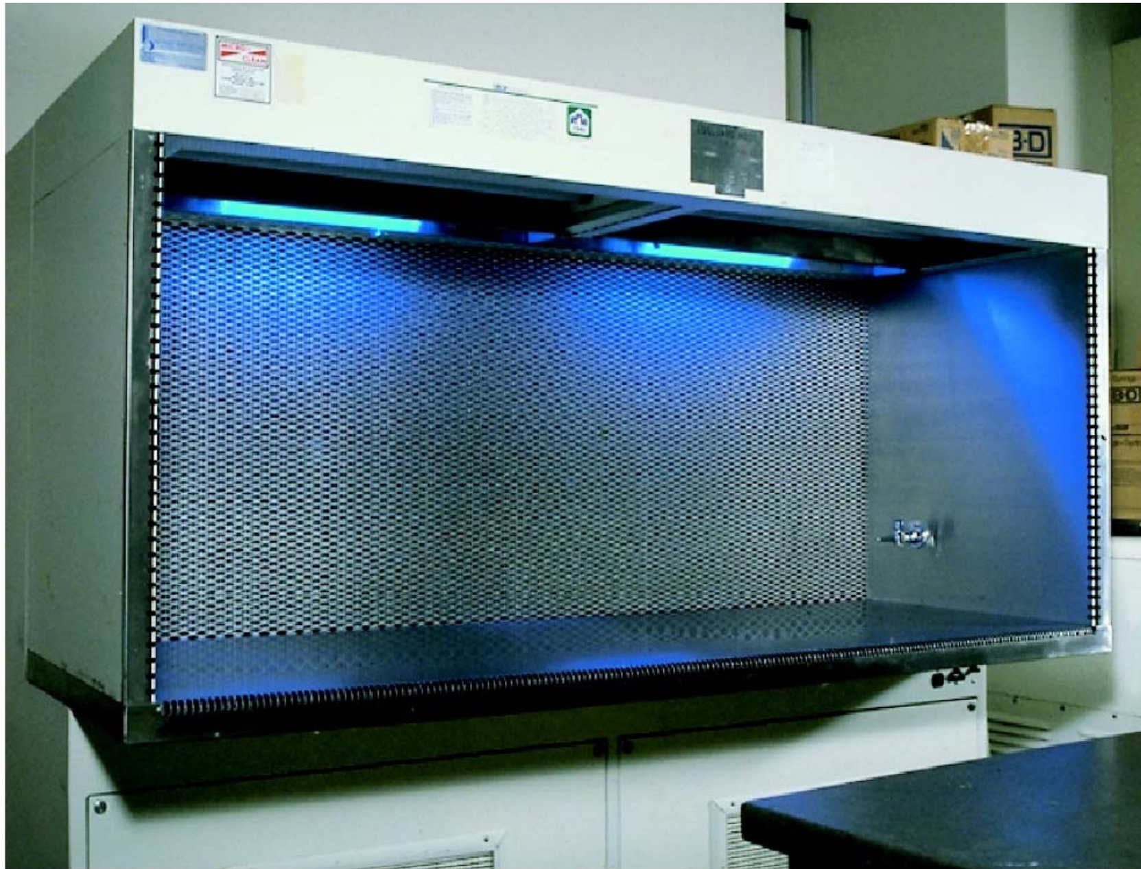
θάλαμος νηματικής ροής βιολογικού εργαστηρίου εφοδιασμένος με πηγή υπεριώδους ακτινοβολίας (λυχνία ατμών υδραργύρου)
