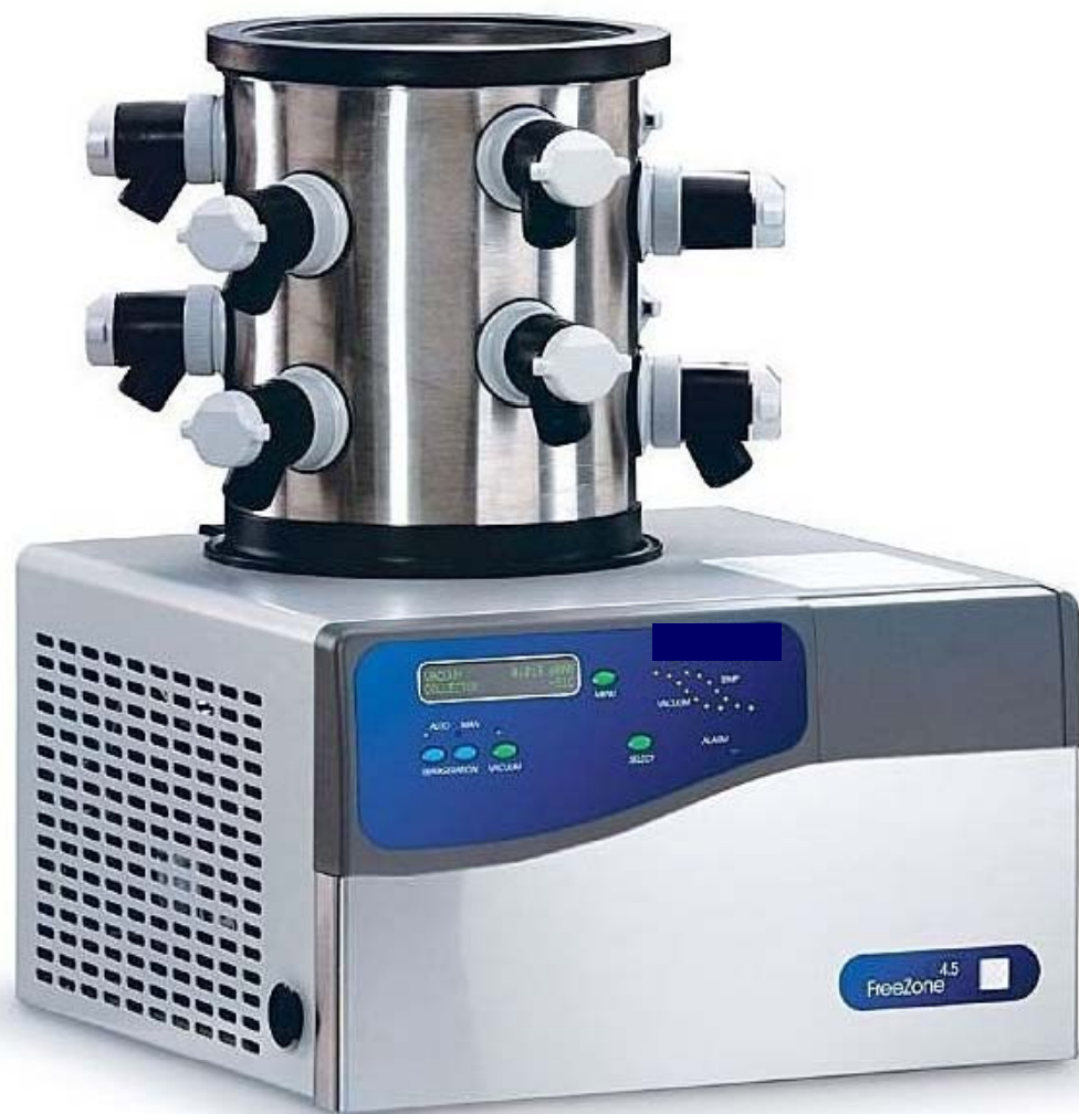
σύγχρονη συσκευή λυοφυλίσωσης μικροοργανισμών
