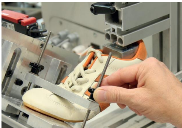
Figura 11. Testarea durabilității încălțăminteii. Sursa: https://pfi.hk/resources/an-overview-of-various-test-methods-of-flexing-durability-for-footwear/
