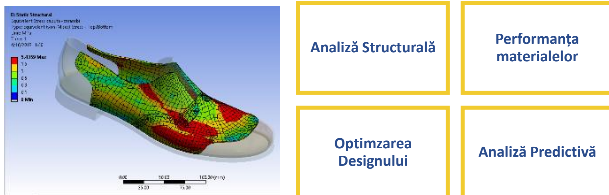
Figura 13. Rolul analizei cu elemente finite ca instrument de analiză a produselor de încălțăminte. Credit: TUIASI
