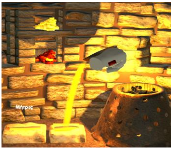
Εικόνα 14: Βήμα 4 – το χύσιμο του λιωμένου μετάλλου στις μήτρες
