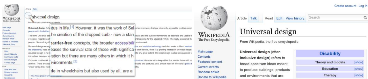
Εικόνα Β-3. Αριστερά: η χρήση του μεγεθυντικού φακού στο προσωπικό υπολογιστή. Δεξιά η χρήση του zoom (Ctrl +) μπορεί να μεγεθύνει κατά πολύ το περιεχόμενο – εδώ ασφαλώς είναι απαραίτητο να μην καταστρέφεται η διάταξη και να παραμένουν ορατές οι βασικές επιλογές πλοήγησης.
