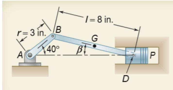
Ωρολογιακή περιστροφή της AB με  $\omega=2000 \text{ rpm}$
