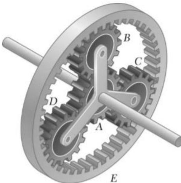
Η ακτίνα όλων των γραναζιών είναι και του εξωτερικού 3<sup>α</sup>. Η γωνιακή ταχύτητα του Ε είναι γνωστή (180 rpm) και ωρολογιακή σε φορά και το γρανάζι Α έχει επίσης γνωστή γωνιακή ταχύτητα επίσης ωρολογιακή (240 rpm).
