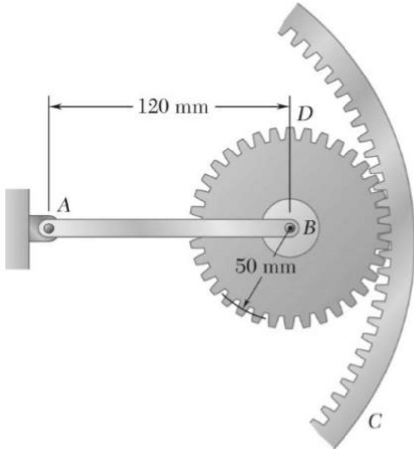
Η ράβδος ΑΒ περιστρέφεται με γωνιακή ταχύτητα  $20 \text{ r/s}$  ωρολογιακά. Αν το εξωτερικό γρανάζι είναι σταθερό να βρεθεί η γωνιακή ταχύτητα του γραναζιού Β και η ταχύτητα του δοντιού στο D
