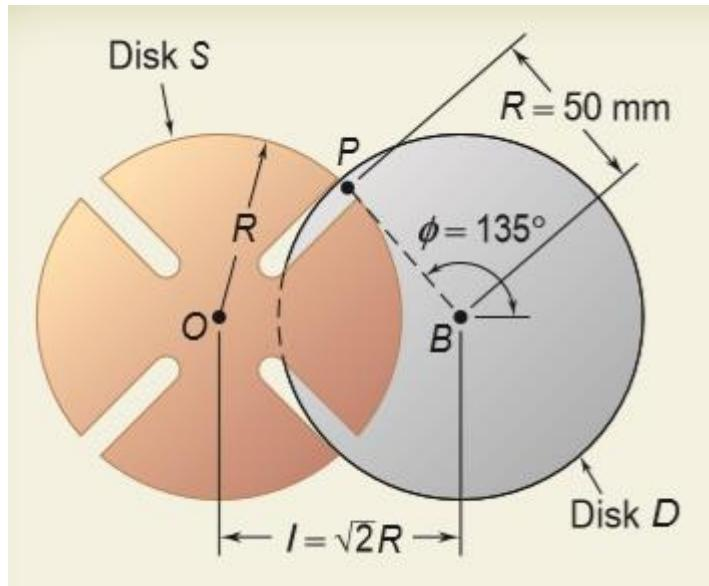
Ο δίσκος D περιστρέφεται ανθωρολογιακά με σταθερή γωνιακή ταχύτητα  $10\text{r/s}$ . Ο πείρος P είναι κολλημένος στον D και γλιστρά στις εσοχές του δίσκου S. Θεωρείται ότι η γωνιακή επιτάχυνση του δίσκου S είναι 0 όταν ο πείρος μπαίνει ή βγαίνει από μια εσοχή. Για γωνία  $\phi=150^\circ$  να βρεθεί η γωνιακή επιτάχυνση του δίσκου S και η επιτάχυνση του πείρου
