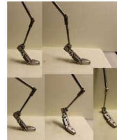
Εικόνα 41 Λειτουργία άρθρωσης πατούσας
