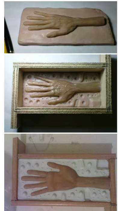
Εικόνα 61 α) μορφοποίηση clay bed β) λίπανση επιφανειών γ) τελιωμένο τμήμα καλουπιού (κάτω μέρος)
