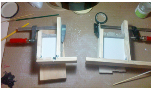
Εικόνα 62 διαδικασία στεγνώματος των καλουπιών της κεφαλής και των χεριών
