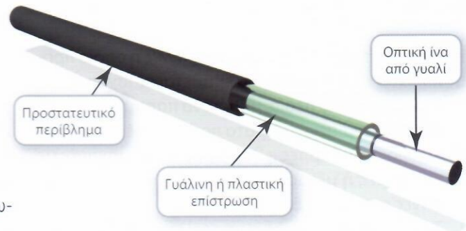
Εικόνα 12.16 Το καλώδιο οπτικών ινών αποτελείται από μια γυάλινη ή πλαστική ίνα (ή δεσμίδα ινών), μια γυάλινη ή πλαστική επίστρωση και ένα προστατευτικό περίβλημα.
